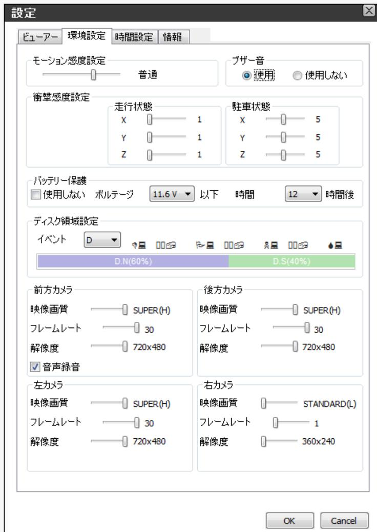
1. モーション感知感度：(駐車中) 動きを感知するセンサーの感度を調節します。高 / 普通 / 低 / 未使用の4段階になります。
